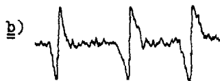
Abb; ESR-Spektrum der benzolischen Lösung von \text{PhSO}_2\text{Cl} : a ) bei der UV-Bestrahlung, b ) 2 Min. nach dem Ende der Bestrahlung
